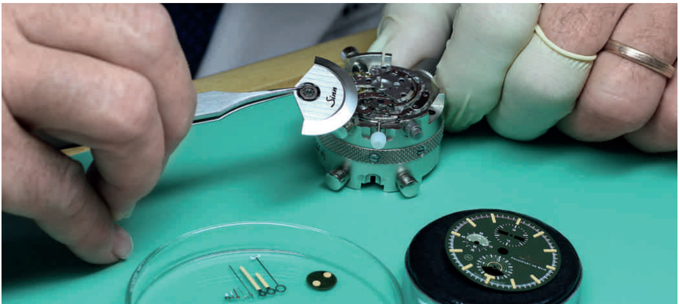
Das fein veredelte Uhrwerk der JAGDUHR 3006 wird mit der Montage des Aufzugsrotors komplettiert. Die filigranen Zeiger, das Zifferblatt und die Mondscheibe liegen zur Montage bereit.
