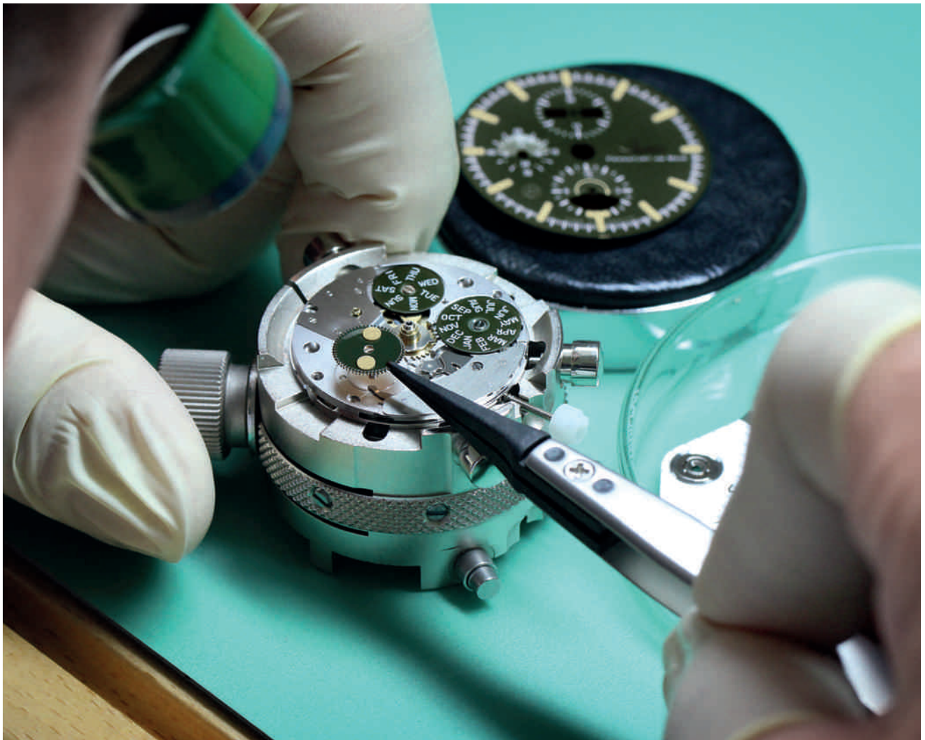
Präzisionsarbeit bis ins kleinste Detail: Auch beim Setzen der Mondscheibe der JAGDUHR 3006 ist höchste Konzentration gefragt.
